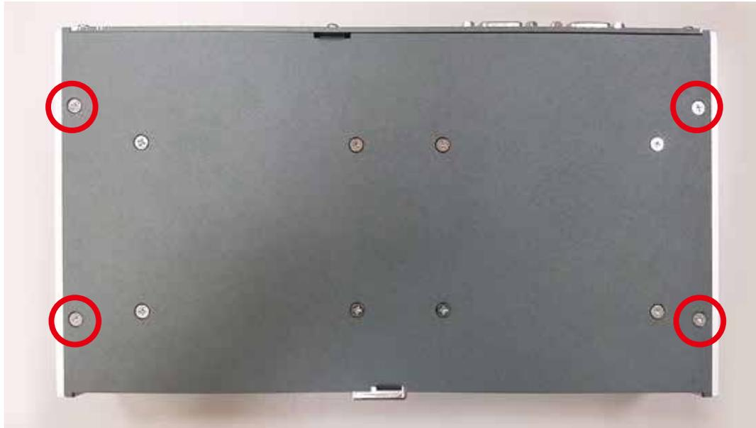
**Paso 4** Saque 1 pieza, el tornillo KHS#6-32 (redondeado en rojo) en la parte posterior.
