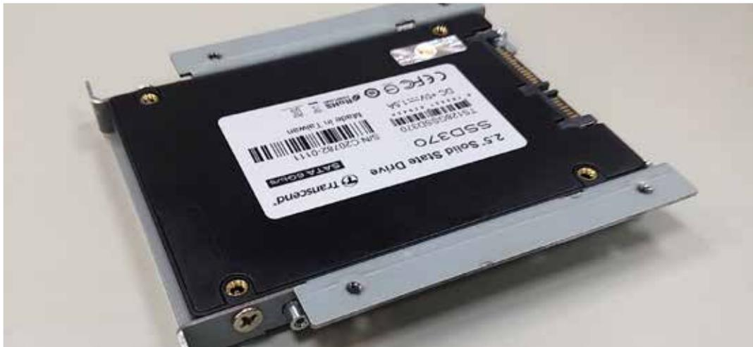
**Paso 6** Fije el SSD/HDD en la estructura con los tornillos M3x4.
