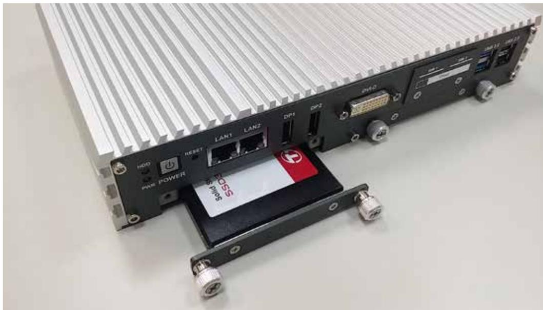
**Paso 4** Asegure los cierres en cada bandeja SSD/HDD.
