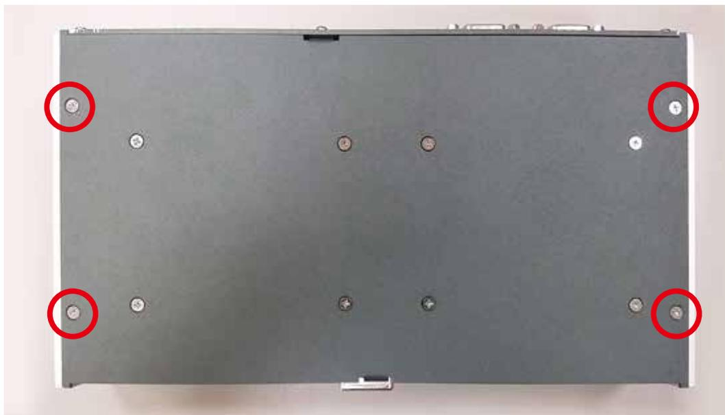
**Paso 6** Saque 1 pieza, el tornillo KHS#6-32 (redondeado en rojo) en la parte posterior.
