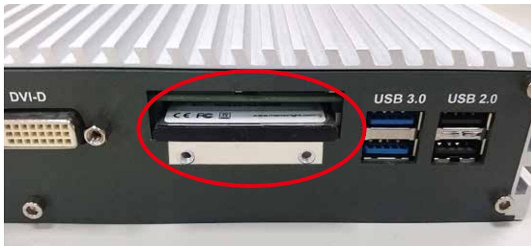
**Paso 4** Antes de insertar la tarjeta SIM, asegúrese que el sistema de alimentación está desconectado.
