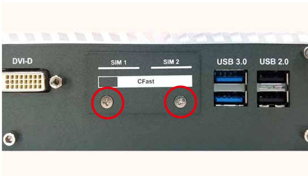
**Paso 2** Quite la cubierta de la tarjeta CFast y la tarjeta SIM del panel frontal.
