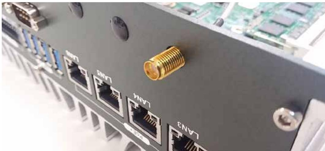
**Paso 4** Ajuste las arandelas 1, 2 y 3 en el conector del cable de antena.
