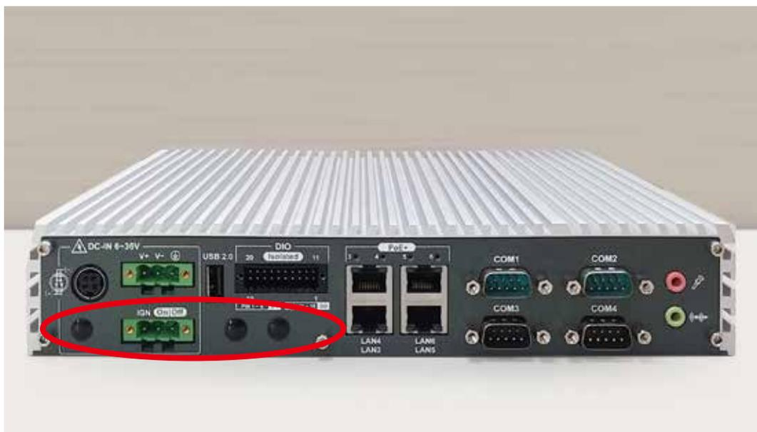
**Paso 3** Ponga el cable para antena en el orificio del panel posterior.
