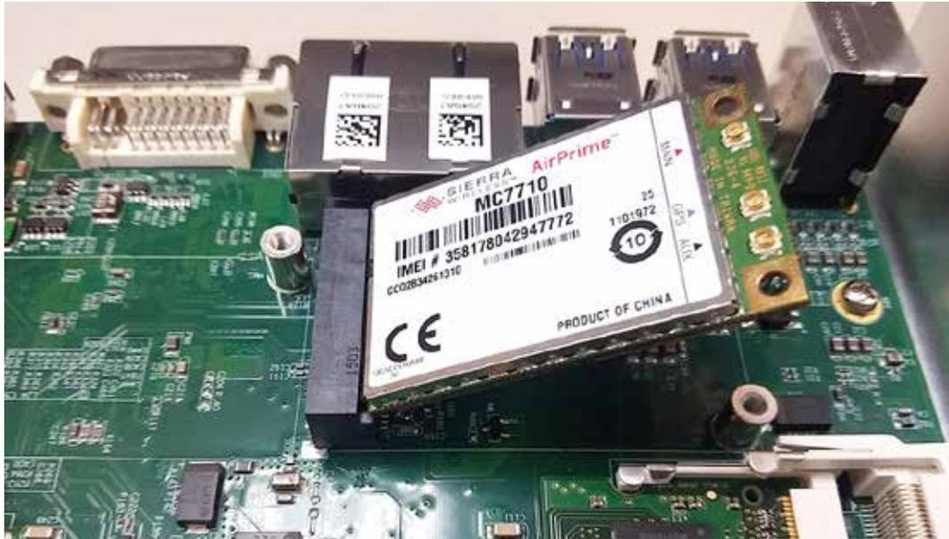
**Paso 2** Ajuste dos piezas, los tornillos M2.5.
