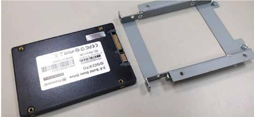
**Paso 5** Asegure los 4 tornillos M3 para fijar el SSD/HDD en la estructura.
