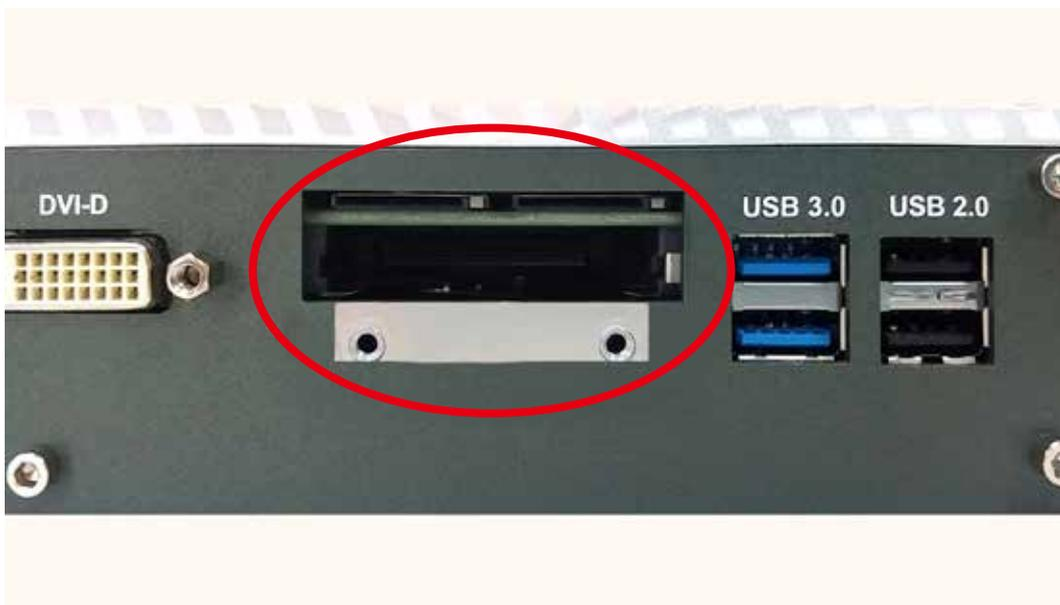
**Paso 3** Inserte la tarjeta CFast y presione hasta que quede fijada.
